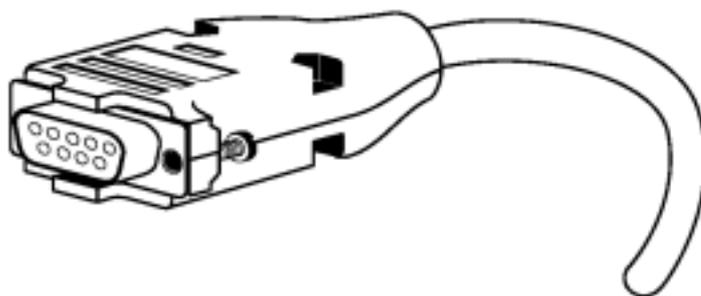
**注意：**为了获得最佳性能和 ESD 保护，请使用 5 级电导屏蔽缆线。对打印机或 CRT 终端接头使用金属外壳，并将缆线的屏蔽物连接到金属外壳和 RS232 插头的套管（标志着接地）上。
